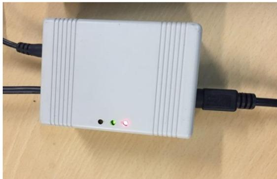
As dimensões do dispositivo são: 65mm x 90mm x 36mm.
