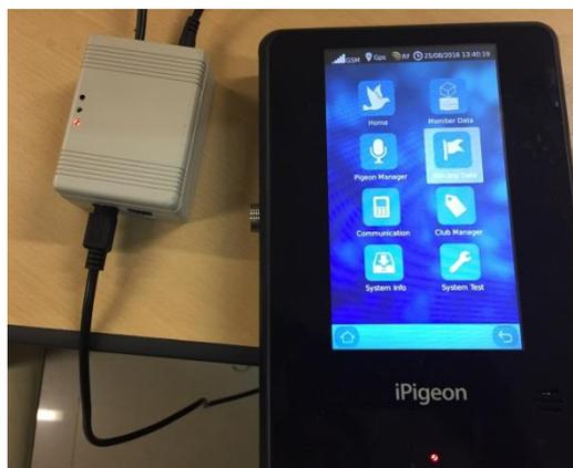
Embora não seja necessário ter dois relógios para corridas realizadas simultaneamente, para aqueles que preferem usar dois relógios, é possível utilizar o dispositivo Loft Recorder para conectar dois relógios à sua antena de pombal e esse dispositivo continuará a registrar a chegada dos pássaros para
