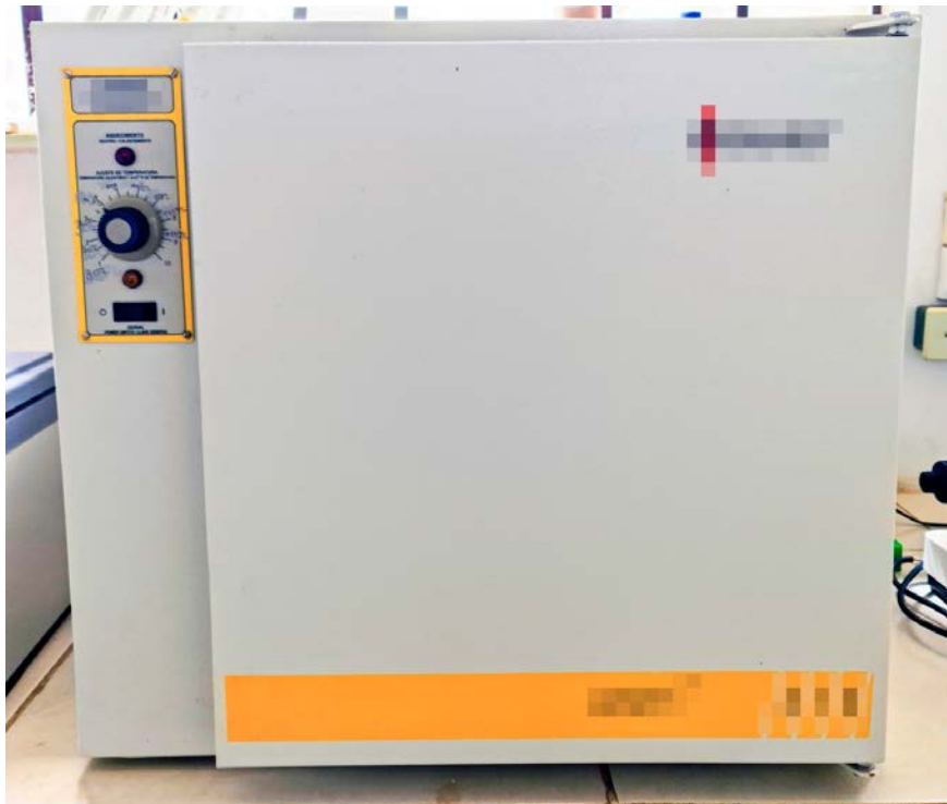
Figura 1- Exemplo de estufa de esterilização (calor seco). Estas estufas ultrapassam a temperatura interna de 200 °C
